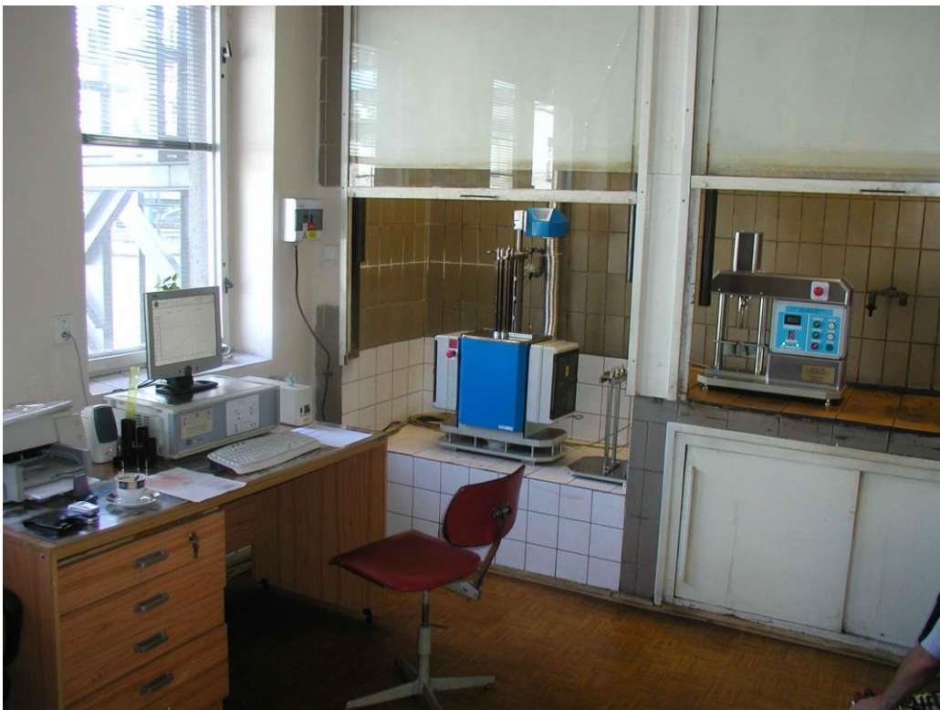
Sestava pro dilatometrická měření v laboratoři.
